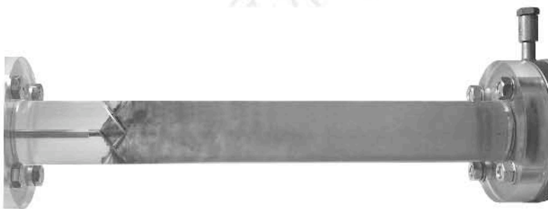
Abbildung 1. Beim Mischen im turbulenten Strömungszustand werden die Medien durch Verwirbelungen homogenisiert (Aquamix, Wasser von links nach rechts, w = 0,3 \text{ m s}^{-1} , Additiv: blau eingefärbtes Wasser konzentrisch dosiert).
