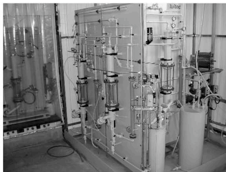
Abbildung 17. Pilotanlage für eine kontinuierliche Gas/Flüssig-Reaktion mit vollständigem Umsatz des Gases.
