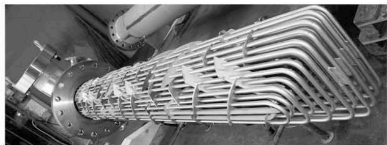
Abbildung 6. Mischer-Wärmetauscher CSE-XR für Polymere (DN 350, PN 400).
