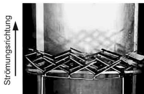
Abbildung 9. Der Memory-Effekt macht sich die Eigenstabilität erzwungener Konvektionen zu Nutze. Dies ist anhand der nach dem Mischer fortgesetzten blauen Schichten gut erkennbar (Wasser mit ca. 5 \text{ mm s}^{-1} , Additiv: blau eingefärbtes Wasser).
