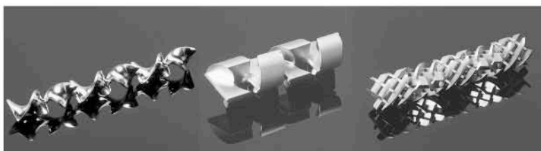
Abbildung 2. Verschiedene Anwendungen und Ansprüche erfordern unterschiedliche Geometrien von statischen Mixern. Von links nach rechts: Wendelmischer, CSE-Mischer, X-Mischer mit 4 Stegen.
