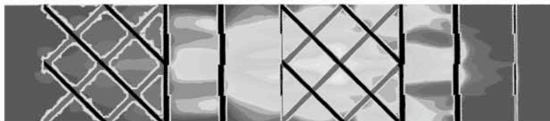
Abbildung 8. CFD-Simulation der Strömungsgeschwindigkeiten in einem X-Mischer. Gut ersichtlich sind der radiale Stofftransport und die enge Verweilzeitverteilung (Strömungsrichtung: von links nach rechts).
