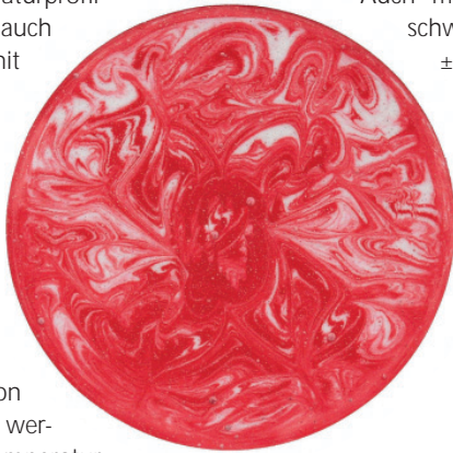
3: Epoxyschnitt eines CSE-XR-Wärmeübertragers nach einer relativen Länge L/D = 5
