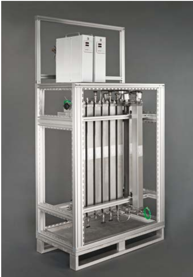
ContiplantPILOT Rack mit redundanten Reaktoren und Verweilzeitstrecke
