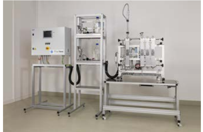
Komplettes ContiplantPILOT-System (Loop-Reaktor mit Verweilzeitstrecke) inkl. zwei Dosiersysteme und Anlagensteuerung
