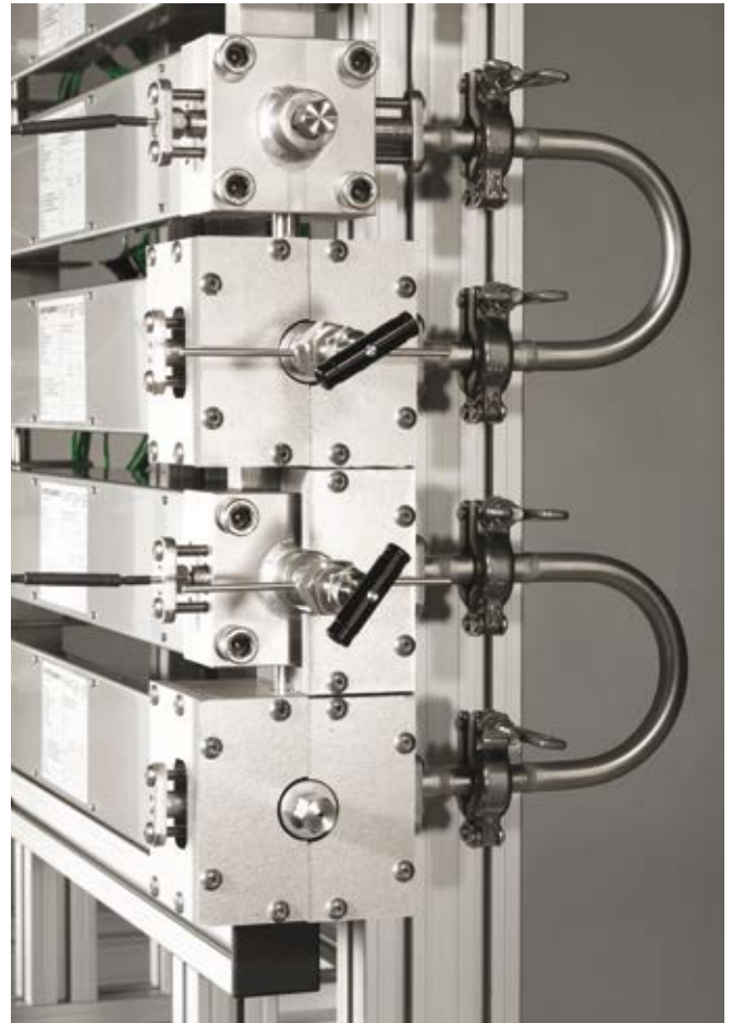
ContiplantPILOT Reaktoren mit standardisierten Ventilen und Sensoren
