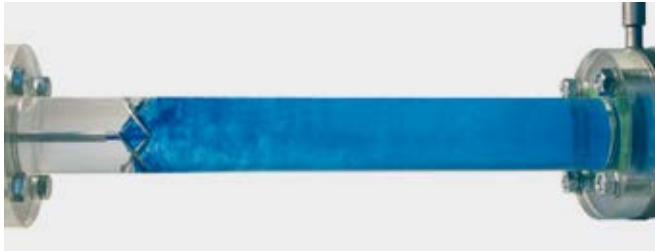
5% blaues Additiv wird vor einem Aquamix zudosiert (Re = 18000)
