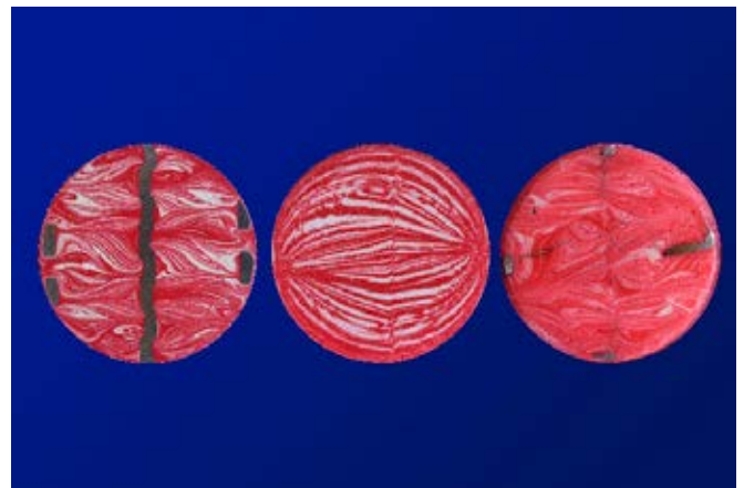
Schnittbilder von Epoxydharz-Mischungen, welche bei vergleichbaren Bedingungen hergestellt wurden. Der Schnitt links zeigt einen CSE-X/8 Mischer nach einem L/D = 3 . Der Schnitt in der Mitte zeigt einen Wendelmischer nach 6 Mischelementen ( L/D = 9.6 ). Das Schnittbild rechts zeigt eine CSE-XC/4 Mischung nach einem L/D = 4 .
