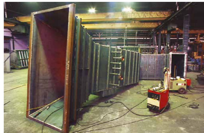
Canalisation de fumée pour une installation DeNOx
