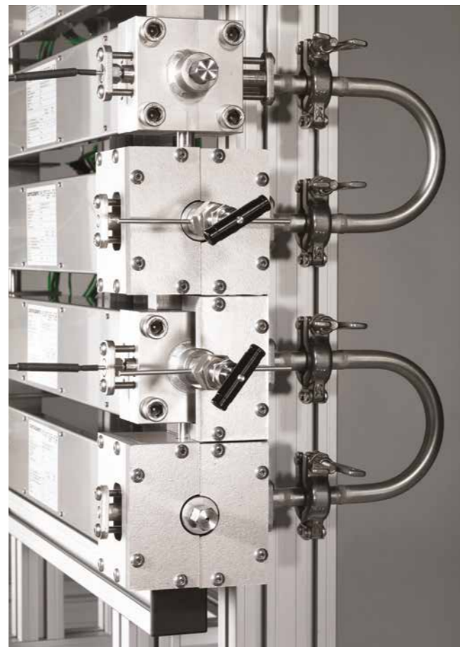
Réacteurs ContiplantPILOT avec vannes et capteurs standards
