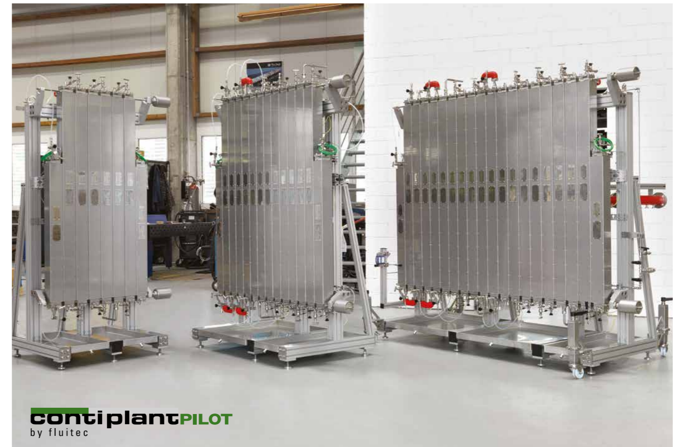
Système réactionnel ContiplantPILOT en Hastelloy C-22, incl. prélèvements, disques de rupture, mesures de pression et de températures
