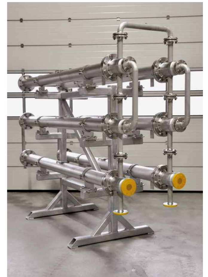
Réacteur à temps de séjour avec temps de séjour > 2 heures
