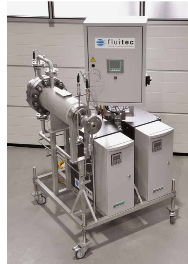
Refroidisseur de polymère avec régulation de la température de sortie du polymère
