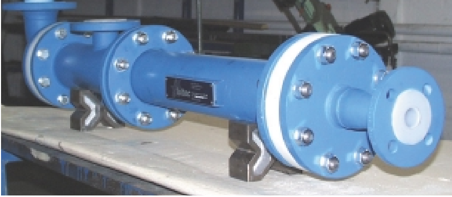
5: FSB-Reaktor mit Teflonbeschichtung
