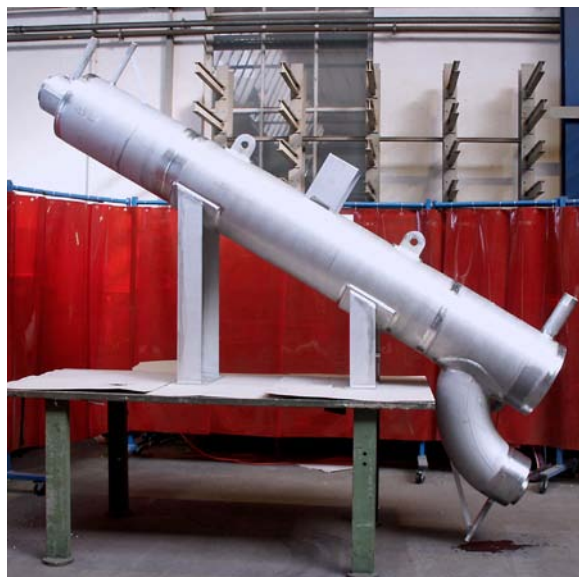
Abb. 2 CSE-XR Faser-Kühler PN320
