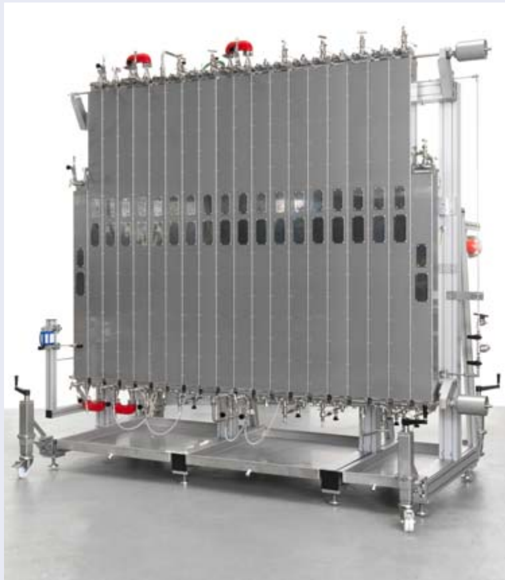
Kontinuierlicher Contiplant-Pilot-Reaktor aus Hastelloy C-22
