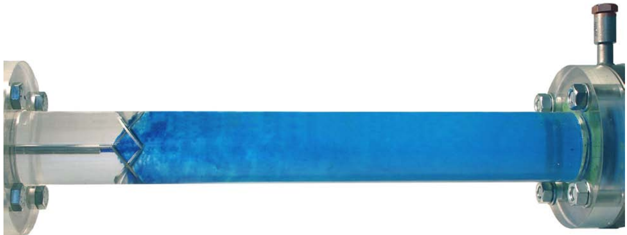
Abb. 1 5% blaues Additiv wird vor einem Milkmix Mischer zudosiert ( Re = 18000 )
