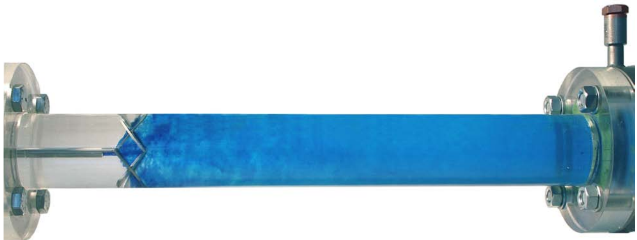
Abb. 1 5% blaues Additiv wird vor einem Aquamix resp. Flash Mischer zudosiert ( Re = 18000 )
