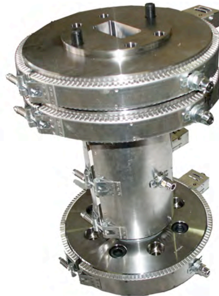
Abb. 5 Schmelzemischer mit Gehäuse Die kompakte und stabile Konstruktion erlaubt bei Betriebsdrücken bis 500 bar einen Druckverlust bis 100 bar.
