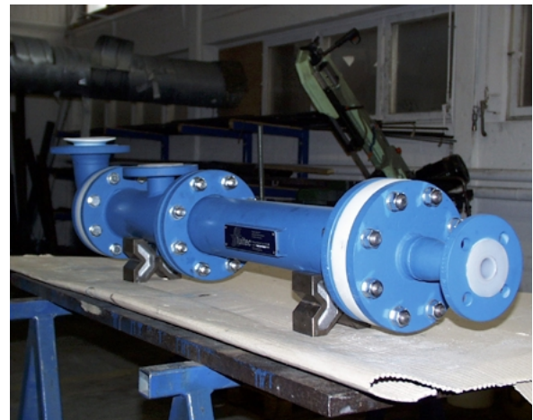
Abb. 6 FSBR-Reaktor DN100, teflonbeschichtet
