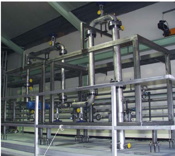
Abb. 4 Polymeranlage mit KMD Dosiermodul, statischen Hochdruckmischern sowie CSE-XR Mischer-Wärmetauscher
