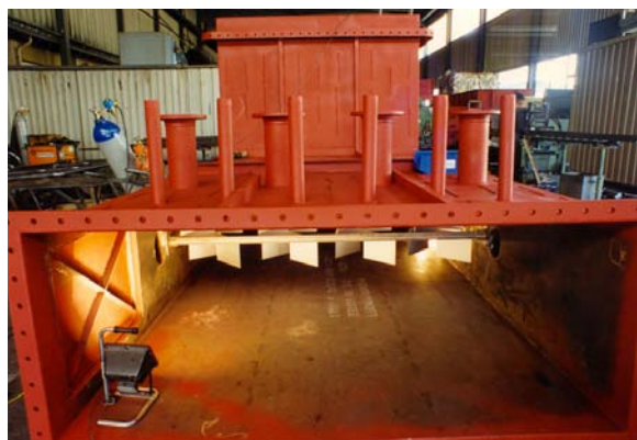
Abb. 6 Rauchgaskanal mit statischen Mixern
