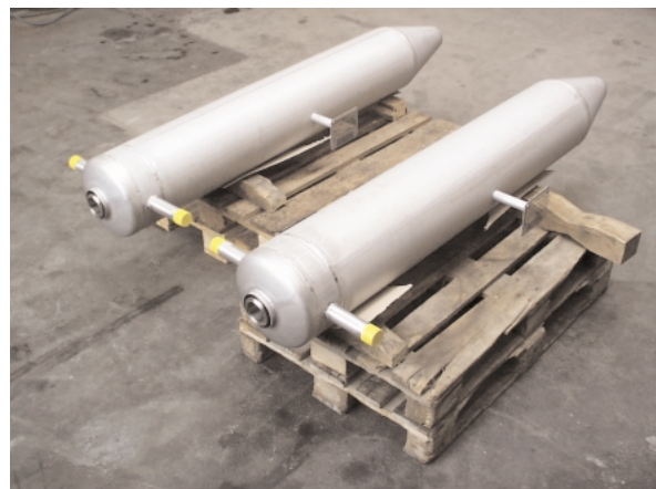
Abb. 5 CSE-XR Polymerkühler für PET-Schmelze
