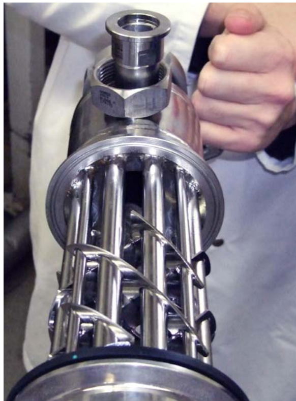
Abb. 3 Kundenkontrolle eines Fluitec Mischer-Wärmetauschers nach erfolgter CIP-Reinigung
