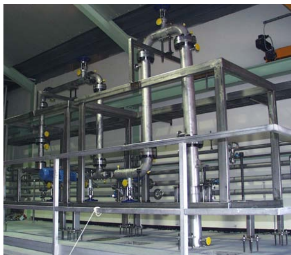
Abb. 3 zeigt einen isotherm betriebenen Kreislaufreaktor für eine radikalische Polymerisation. Diese Fluitec Pilotanlage besitzt eine Kapazität von 1500 Tonnen pro Jahr.
