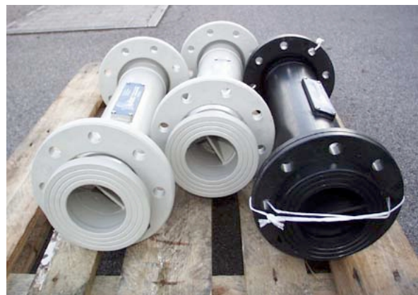
Abb. 1 Fluitec Mischer aus PP und PE
