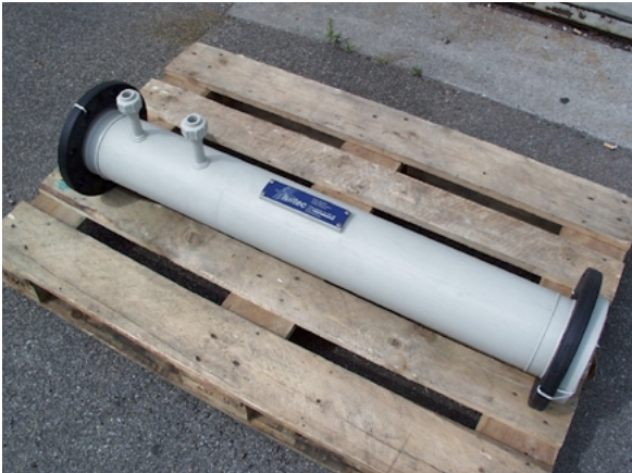
Abb. 2 Fluitec Mischer mit 2 Impfstellen
